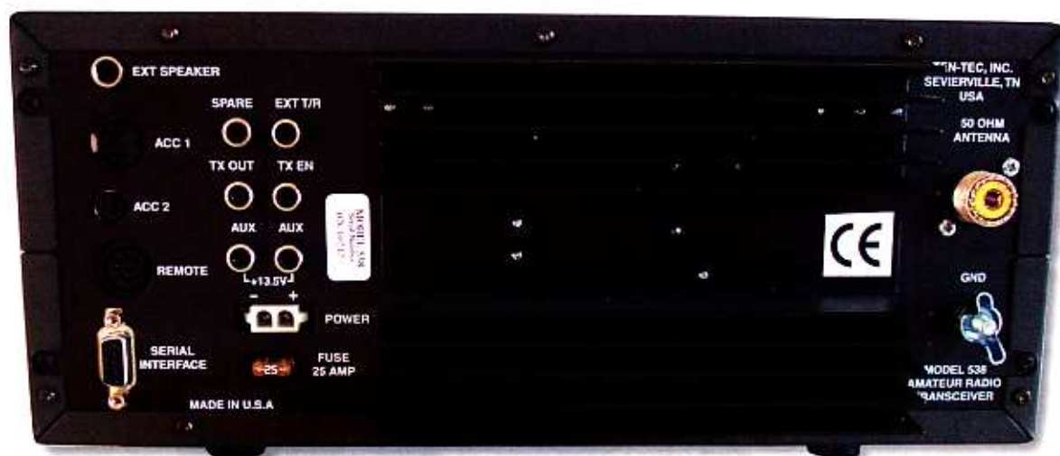
De aansluitingen aan de achterzijde.
